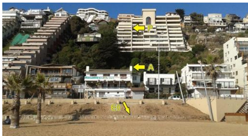
Figura 2 Ejemplo de definición de estación de referencia y puntos de orientación anterior y posterior.
