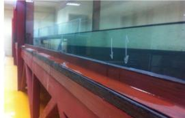
Durante la primera prueba de estanqueidad se procedió con el sellado por el interior y exterior del canal, removiendo los perfiles que fueron soldados para la fijación del vidrio. Se efectuó una alineación de las ménsulas de posición del slider del motor y se realizó el montaje de viga para restringir el momento generado por el oleaje reflejado.
